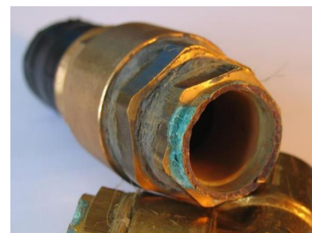
Eksempel spændingskorrosion i messingfiting
